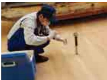
写真④ 空中の菌をサンプリングしてカビ発生状況の危険性を調べます。
