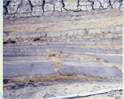
5世紀頃の地震で生じた液状化の痕跡 (松江市・原の前遺跡・県埋蔵文化財調査センター写真提供)
