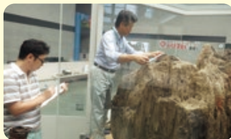
保存処理の時に設置したピンとピンの間を測ってゆがみやヒビに変化がないかを確認する
